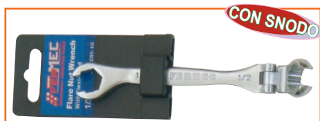
CHIAVE SNODATA ESAGONALE E POLIGONALE PER RACCORDI TUBI CHROM-VANADIUM - CROMATA HRC 44/48
